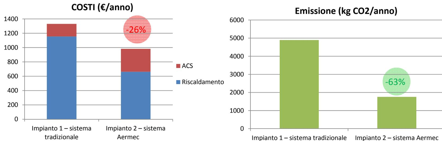
Dai risultati ottenuti emerge che installando una pompa di calore ANLI021H (dotata di tecnologia ad Inverter) con i ventilconvettori, otteniamo un risparmio in termini economici pari ad un **26%** rispetto alla soluzione con caldaia a condensazione.
